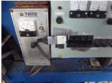
写真 1 DC 電源との接続状況
