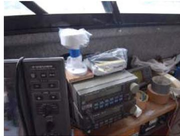
写真 2 GPS データロガーの設置状況
